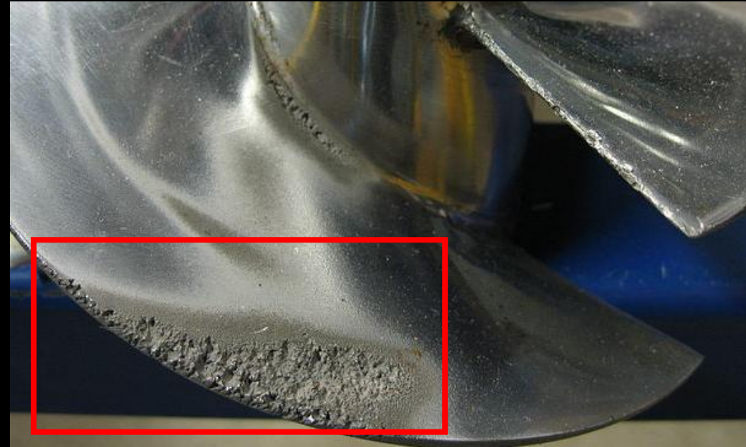
Кавитационные повреждения гребного винта
