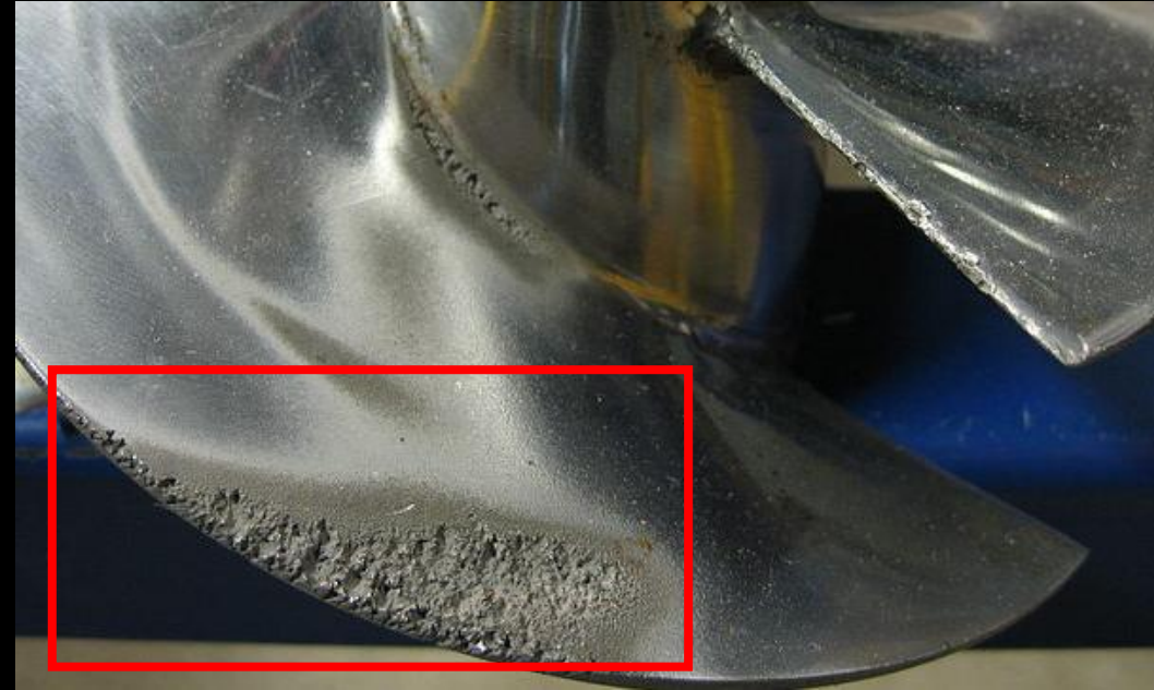
Кавитационные повреждения гребного винта
